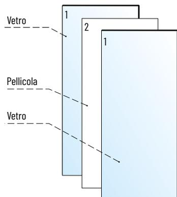
Vetro stratificato composto da due lastre di vetro (1) con interposta una pellicola di materiale plastico PVB (2) trasparente, che aderisce perfettamente alle due superfici di vetro, creando così un'unica lastra. Conforme alle norme UNI EN 14449. In caso di rottura la pellicola interna permette di trattenere i vari frammenti. Le operazioni di pulizia e manutenzione possono venir effettuate con estrema semplicità.
