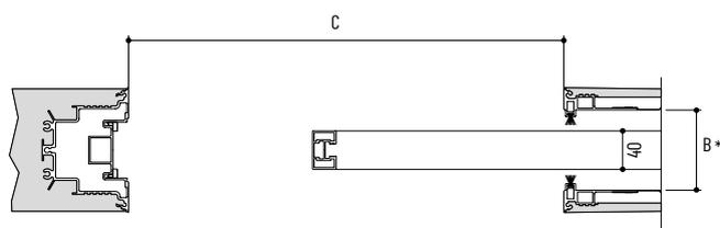
La luce di passaggio una volta installata la porta, si riduce in larghezza di 10 mm per l'anta singola
