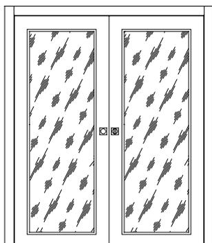
L'anta viene fornita completa di stipiti e coprifilo. E' escluso il kit chiudiscigno.
