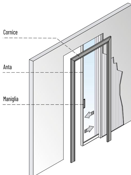
Le ante ACQUA hanno struttura in alluminio e vetri a tamponamento delle stesse e possono essere applicate sul controtelaio Scigno Base.
