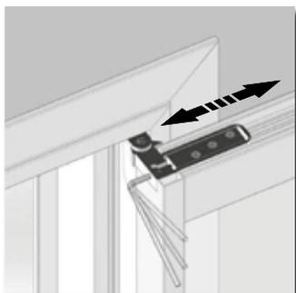
Regolazione pratica e rapida per l'allineamento laterale dell'anta.
