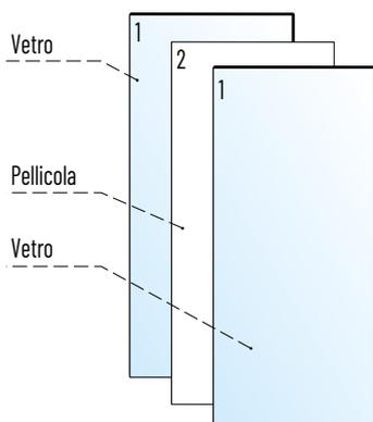
Vetro stratificato composto da due lastre di vetro (1) con interposta una pellicola di materiale plastico PVB (2) trasparente, che aderisce perfettamente alle due superfici di vetro, creando così un'unica lastra. Conforme alla norma UNI EN 14449. In caso di rottura la pellicola interna permette di trattenere i vari frammenti. Le operazioni di pulizia e manutenzione possono venir effettuate con estrema semplicità.
