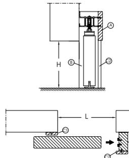
Mantovana e battuta realizzati in MDF nobilitato in superficie con decorativo melaminico, completo di guarnizione sulla battuta. La mantovana e la battuta dovranno sempre essere adeguati alla luce di passaggio durante l'installazione, mediante semplici tagli.
