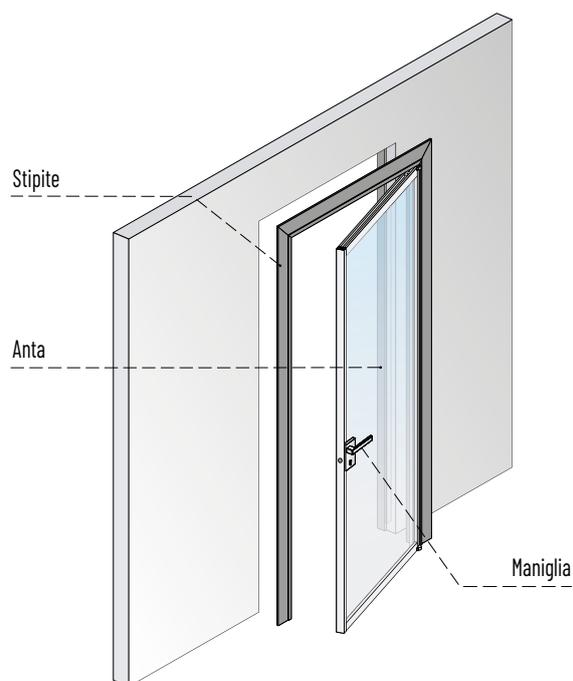
Le porte del sistema Battente possono essere adattate ai vari spessori di muro assecondando le diverse necessità di arredo dei locali a cui vengono destinate.
