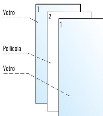
Vetro stratificato composto da due lastre di vetro (1) con interposta una pellicola di materiale plastico PVB (2) trasparente, che aderisce perfettamente alle due superfici di vetro, creando così un'unica lastra. Conforme alla norma UNI EN 14449.
