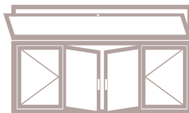
FINESTRA CON SOPRALUCE APRIBILE
