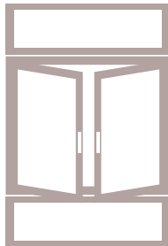
FINESTRA CON SOPRALUCE E SOTTOLUCE FISSI
