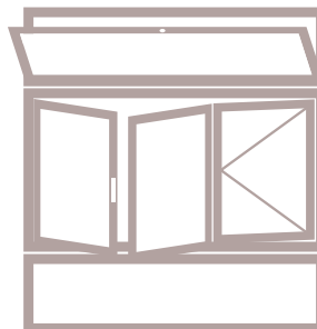
FINESTRA CON SOPRALUCE APRIBILE E SOTTOLUCE FISSO
