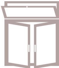
FINESTRA CON SOPRALUCE APRIBILE
