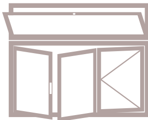
FINESTRA CON SOPRALUCE APRIBILE
