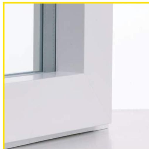
Anche **nella versione Isik A plus**, la finestra raggiunge gli standard conformi CasaClima. Grazie al triplo vetro camera sp. nominale mm. 38 mantenendo inalterate tutte le altre caratteristiche, la finestra ha un'isolamento termico ottimale UW fino a 090W/M2K migliorando inoltre l'isolamento acustico fino a 44 decibel.
