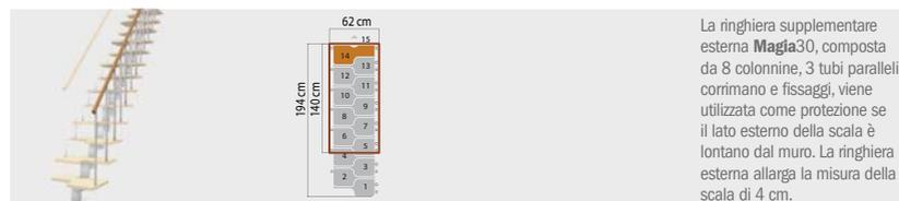
La ringhiera supplementare esterna Magia30, composta da 8 colonnine, 3 tubi paralleli, corrimano e fissaggi, viene utilizzata come protezione se il lato esterno della scala è lontano dal muro. La ringhiera esterna allarga la misura della scala di 4 cm.
