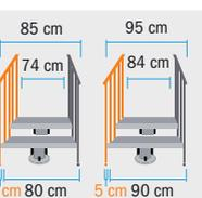
La ringhiera supplementare esterna Magia90.Xtra, composta da 4 colonnine, 5 tubi paralleli, corrimano e fissaggi, viene utilizzata come protezione se il lato esterno della scala è lontano dal muro. La ringhiera esterna allarga la misura della scala di 5 cm.
