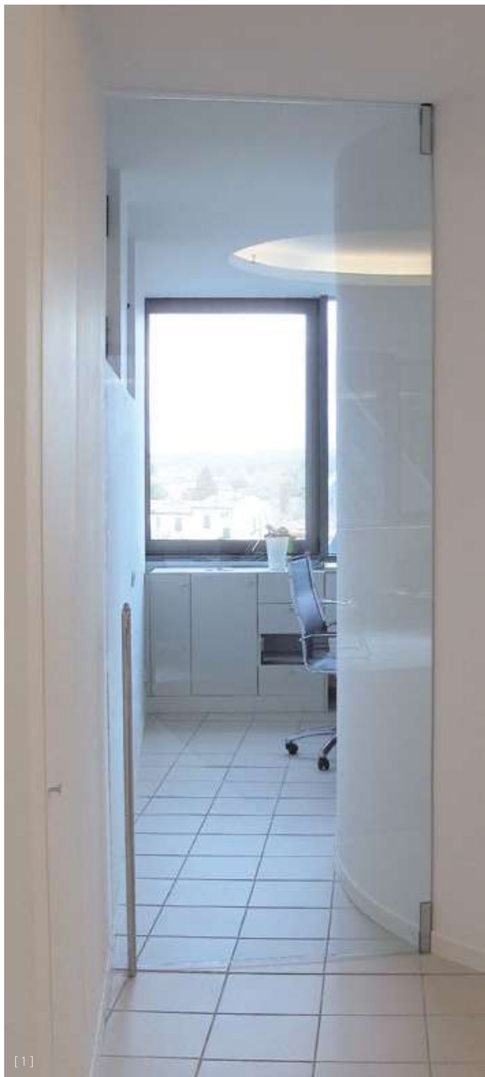
[ 1 ] Porta Rasovitra Vitrabox con cerniera bidirezionale con ritorno automatico in chiusura applicata su parete curva. Utilizzata per dividere gli uffici dal corridoio.
